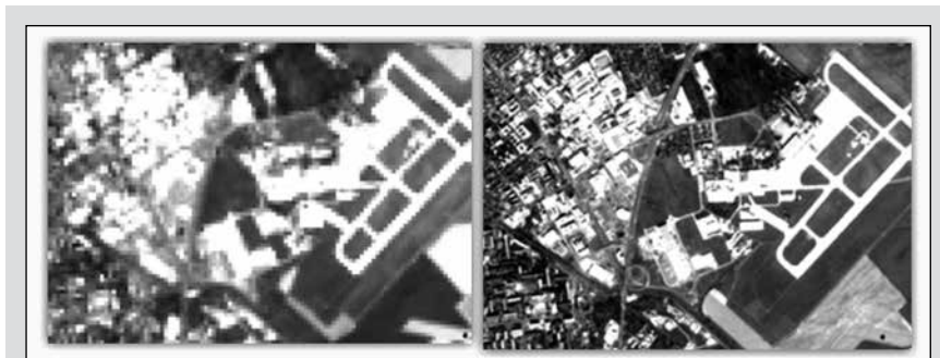
Obrázok 4 Porovnanie družicovej snímky Landsat s rozlíšením 30 m (vľavo) a družicovej snímky Sentinel s rozlíšením 10 m (vpravo)
